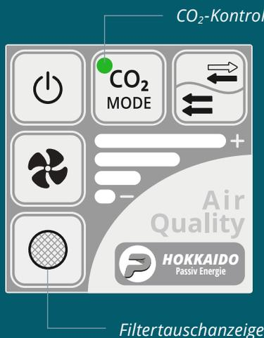
Der **Kontroller VMPX-AQ** mit dem integrierten **CO<sub>2</sub>-Sensor** überwacht die Konzentration von Kohlendioxid in der Raumluft. Ist der Sensor aktiviert, steuert er je nach Lüftungsbedarf stufenlos den Ventilator.
